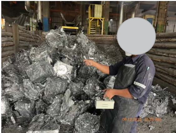
ภาพที่ 1 การสุ่มตรวจวัดสารกัมมันตรังสีในเหล็กก้อน
